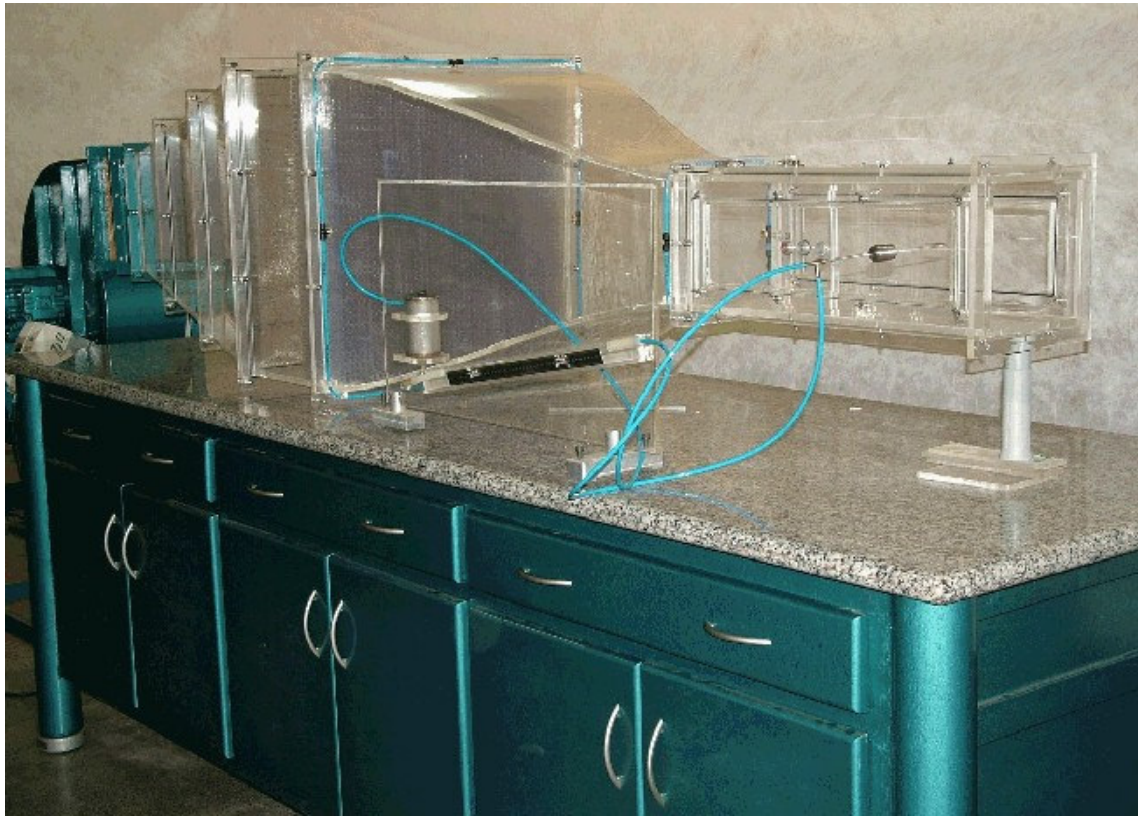
Figura 2: Túnel aerodinâmico soprador da Unesp de Ilha Solteira apresentando um tubo de Pitot inserido no interior da seção de testes conectado a um micro-manômetro.
